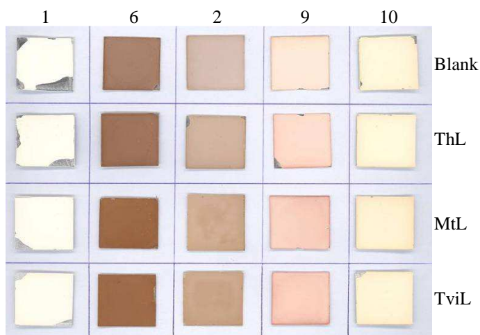
Abbildung 45: Farbreaktionen von modifizierten Siloxanen II auf DC-Platten mit den Enzymen ThL, MtL und TviL nach Trocknen im Trockenschrank
