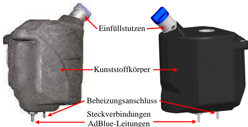
Abbildung 49: AdBlue-Tank von der Firma Elkamet, rechts: 3D CAD-Darstellung
