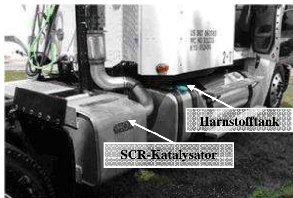
Abbildung 2: Beispiel eines SCR-Systems in einer mobilen Anwendung [Quelle:DieselNet]
