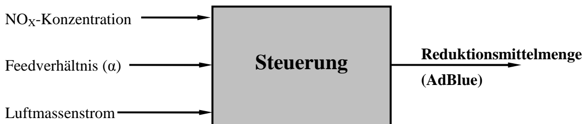
Abbildung 26: Prinzipsskizze zur Ermittlung der erforderlichen Reduktionsmittelmenge
