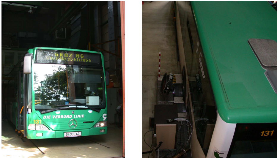
Abbildung 55: Stadtbus als Versuchsfahrzeug auf dem Rollenprüfstand
