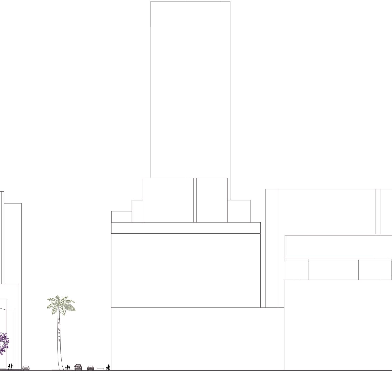
Das Gebäude A springt im siebten Obergeschoß zurück, damit die unteren Büros in Gebäude B besser belichtet werden.
