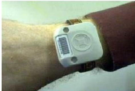
Abbildung 42: RFID- Tag des HERMES- Projektes<sup>66</sup>
