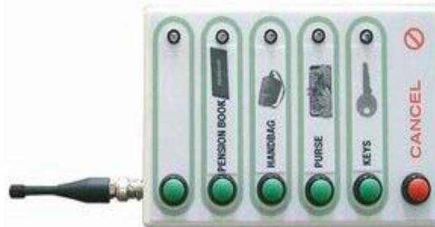
Abbildung 29: Bedienpanel der Auffindungshilfe des ENABLE- Projektes<sup>51</sup>.
