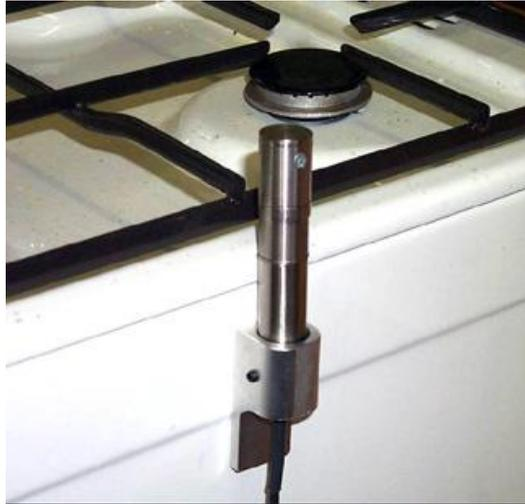
Abbildung 30: ENABLE- Temperaturfühler des Gasherds-Monitoring- Systems<sup>52</sup>
