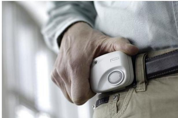
Abbildung 26: Tunstall- „Piper Falldetektor“<sup>48</sup>
