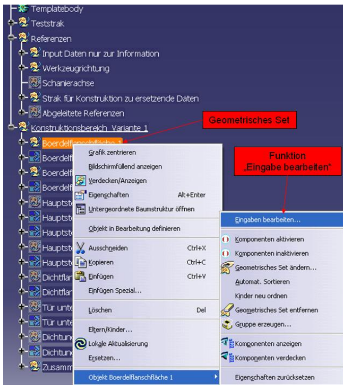
Abbildung 43: Abhängigkeiten eines Geometrischen Sets anzeigen (1/3)
