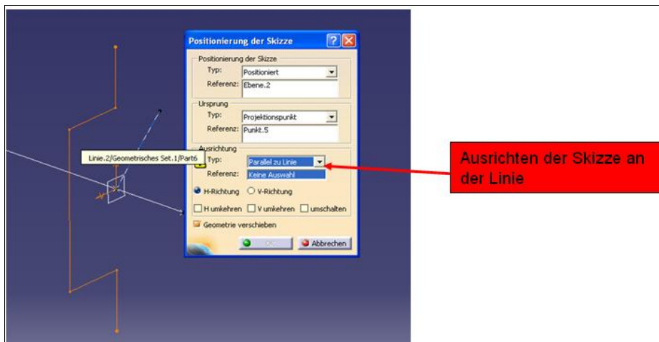
Abbildung 109: Drehung von Schnitten (2/3)
