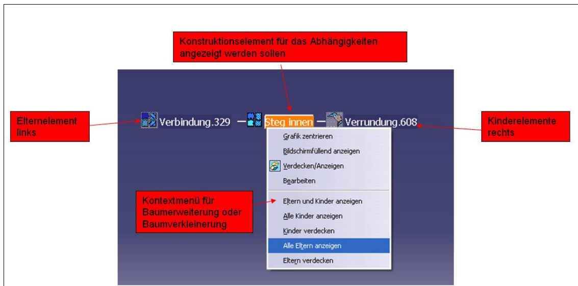
Abbildung 41: Abhängigkeiten eines Konstruktionselementes anzeigen (2/3)
