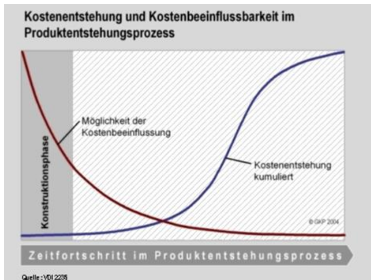
Abbildung 54: Kostenentstehung und Kostenbeeinflussung im Produktentstehungsprozess 15
