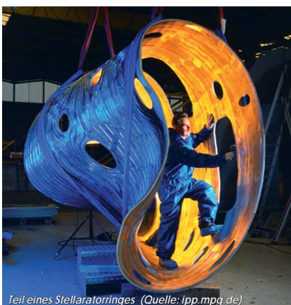
Teil eines Stellaratorringes (Quelle: ipp.mpg.de)
