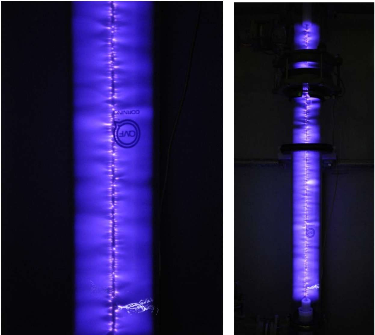
Abbildung 5-8: Bild der Coronaentladung bei 22 [kV] mit der 4 [mm] Bürstenelektrode
