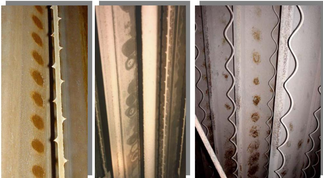
Abbildung 2-9: Bild der lokalen Coronaentladung auf die Niederschlagselektroden [6]
