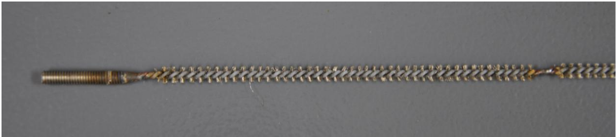
Abbildung 5-9: 4 [mm] Bürstenelektrode mit Fehlstellen
