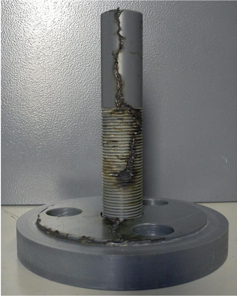
Abbildung 4-2: Überslag auf die Elektrodenhalterung
