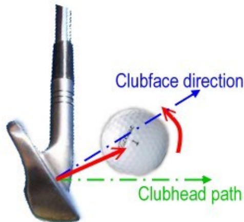
Abbildung 4.4: Winkel-Verhältnisse beim Abschuss eines Golfballes [Tutelman 2010]
