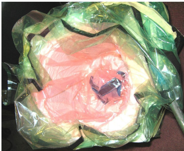
Abbildung 3: CFK-Form mit CFK-Teil in dichter Plastikfolie, Luft bereits abgesaugt.
