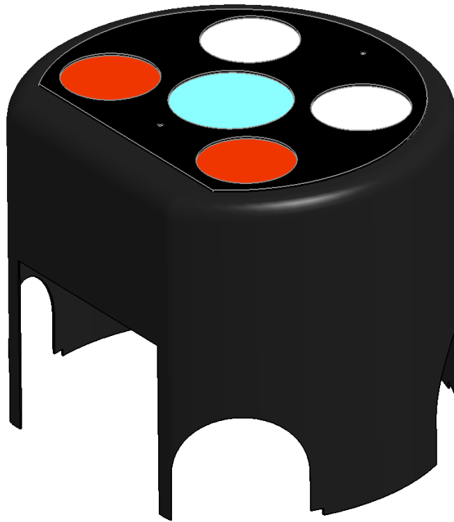
Abbildung 2.42: CAD Modell der Außenhaut des Roboters
