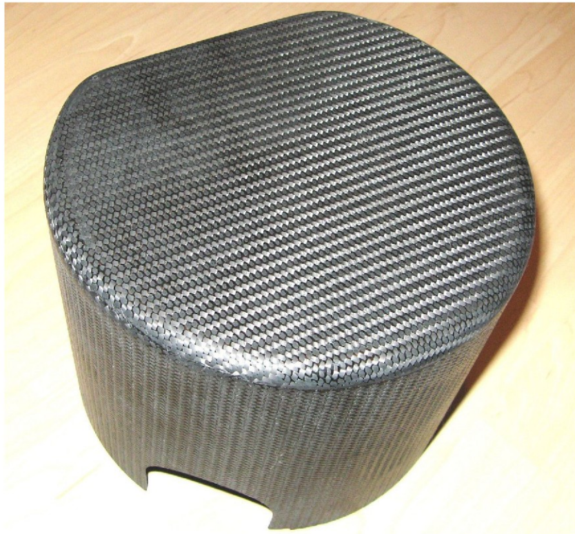
Abbildung 5: CFK-Teil nach den ersten Bearbeitungsschritten
