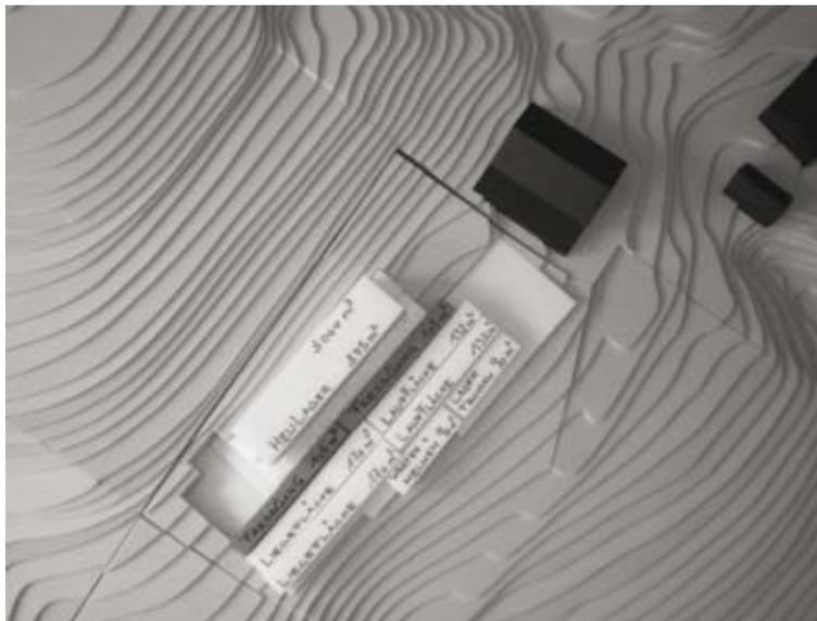
Abb. 97 Volumenermittlung, parallel zu den Höhenlinien
