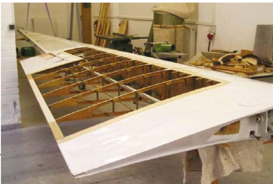
Abb. 177-179 Leichtbaukonstruktion, Modellflugzeug
