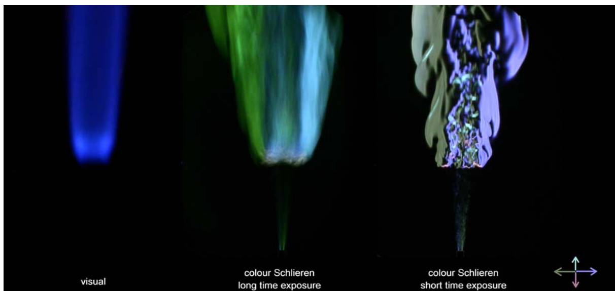
Abb. 4.3.1 Aufnahmen einer reinen \text{CH}_4 -Flamme mit Zuluft. links: Langzeitbelichtung Eigenleuchten ( \sim 1,3 s); mitte: Langzeitbelichtung Farbschlieren und Eigenleuchten ( \sim 1/3 s); rechts: Farbschlieren ( \sim 1/4000 s) (Fontaneto 2008).
