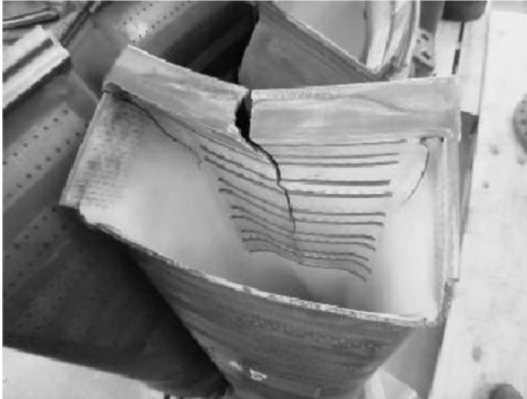
Abb. 1.1.1 An einem Übergangsstück zu einer Brennkammer entstandener Schaden durch Brennkammerpulsationen (Joos 2006 zit. nach Swell et al. 2004).
