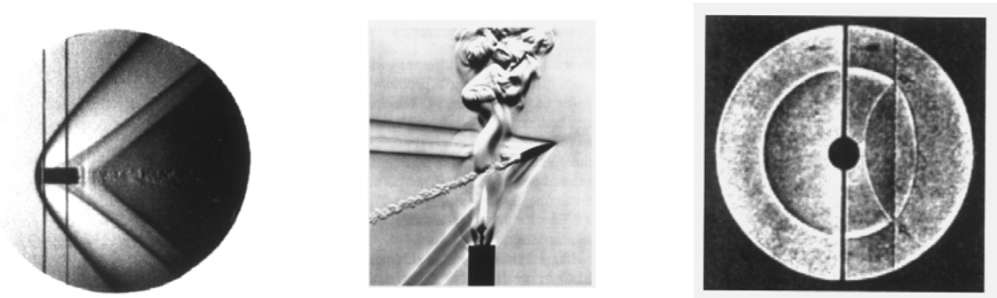
Abb. 2.4.1 v.l.n.r.: Aufnahme der Schockwellen eines Geschosses (Ernst Mach); Schlierenbild einer Gewehrkugel durch eine Kerzenflamme (Hubert Schardin); Zeichnung eines Schlierenbildes, erzeugt durch eine sphärische Schockwelle bei elektrischer Funkenentladung (August Toepler); (Settles 2001).
