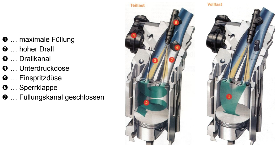
Abbildung 2.3: Twinport-System zur Steuerung der Ladungsbewegung [7]
