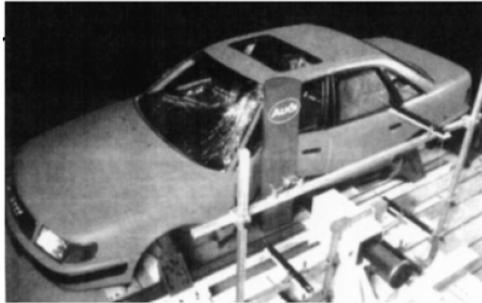
**Abbildung 6.11:** Statischer Türeindrückversuch nach FMVSS 214 a [55]
