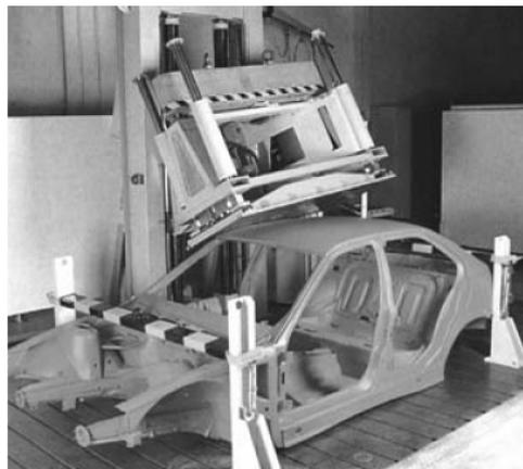
Abbildung 6.10: Statischer Dacheindrucksversuch nach FMVSS 216 [56]
