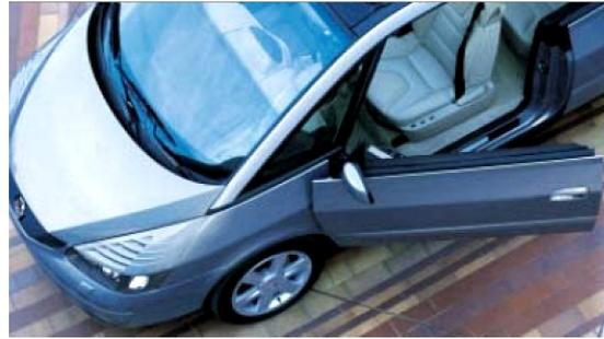
Abbildung 2.11: Eindrehende und aushebende Türkinematik [64]
