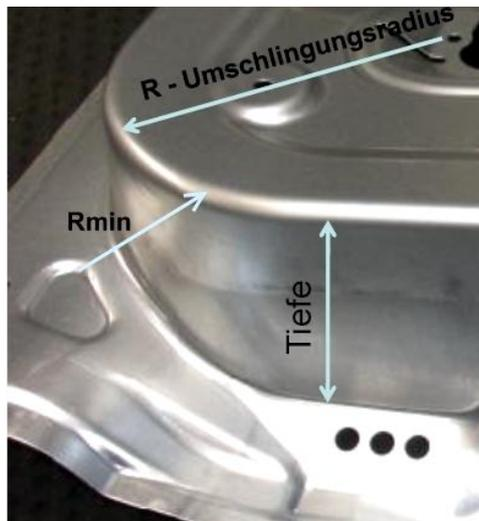
**Abbildung 4.4:** Schematische Darstellung von  $R$  und  $R_{\min}$  [62]
