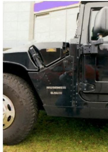
**Abbildung 2.10:** Innen- und außenliegende Scharnierachse [64]
