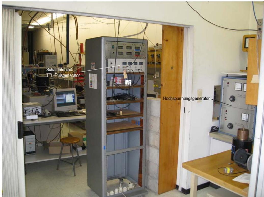
**Abbildung 3.4: Stromlade- und Steuereinheit des Pulsheizexperiments**
