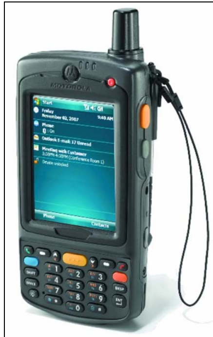
Abbildung 3.5: Mobiles Datenerfassungsgerät MC 75
