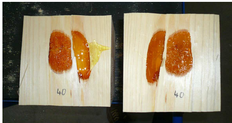
Abb. 3.10 Prüfkörper mit Harzgallen
