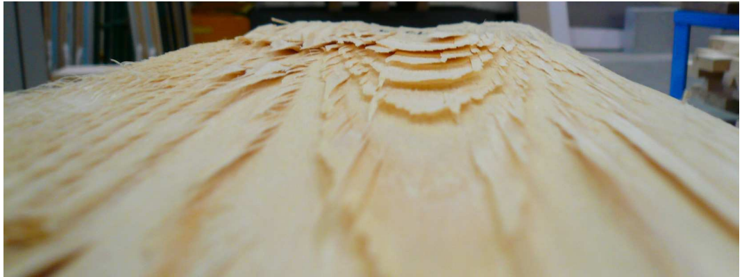
Abb. 3.18 Versagen der Frühholzzone
