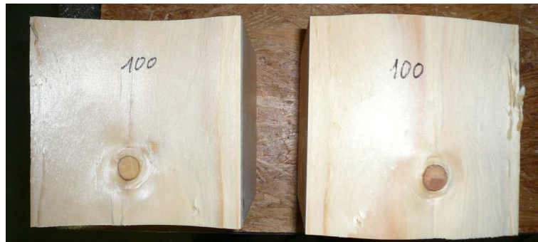
Abb. 3.6 Prüfkörper mit Ast (Belastung des Astes in Faserrichtung)
