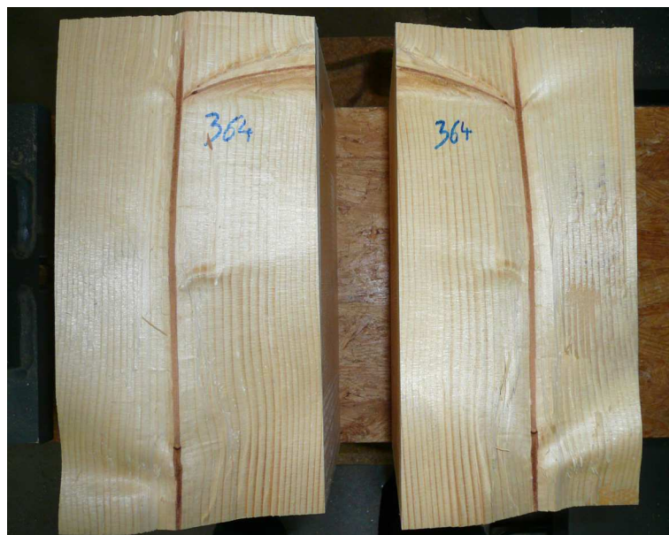
Abb. 3.7 Prüfkörper mit Flügelast (Astbruch)
