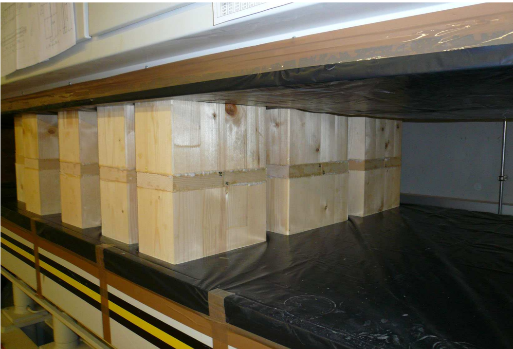
Abb. 2.4 Verklebung der Prüfkörper mit einer Querschnittsfläche von 150 x 150 mm, jeweils 2 Prüfkörper gemeinsam verklebt
