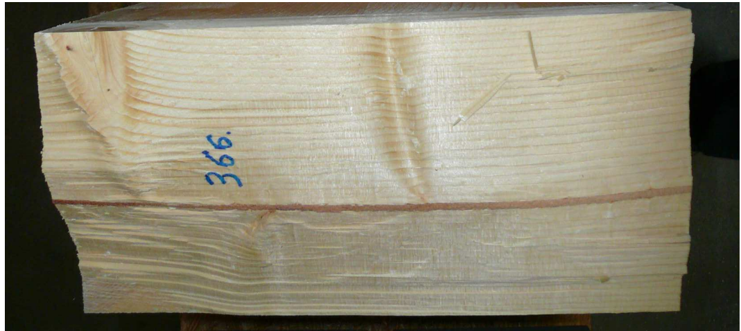
Abb. 3.22 Prüfkörper mit rissauslösendem Mark
