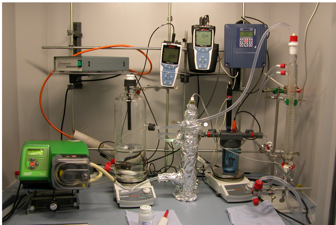
Abbildung 6.13: Versuchsaufbau während eines 1,4-Dioxan Abbaubersuchs
