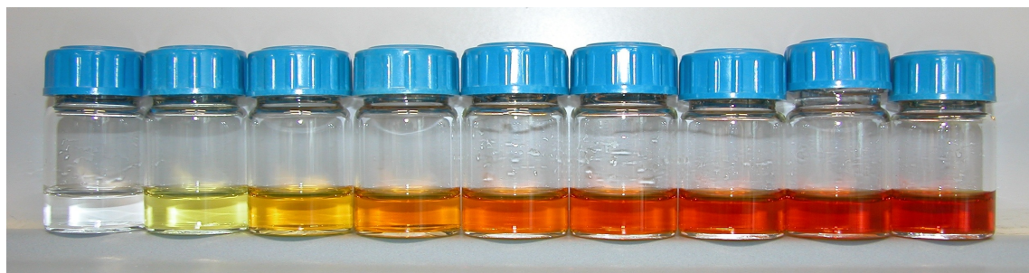
Abbildung 6.12: Aktinometerlösung nach verschiedenen Versuchszeiten
