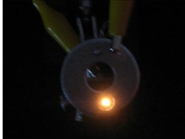
**Abbildung 42:** Simmerbetrieb der Hohlkathodenblitzlampe
