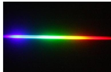
**Abbildung 17:** Lichtspektrum der Halogenlampe
