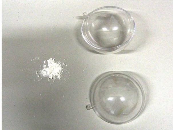
**Abbildung 48:** Bariumsulfatpulver und Kunststoffgrundkörper für die Kugelherstellung
