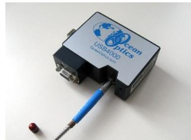
Abbildung 1: Spektrometer USB4000
