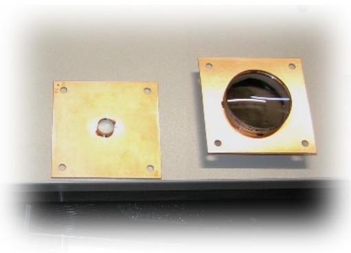
**Abbildung 27:** Linsenmontage am Trägermaterial
