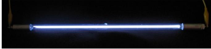
**Abbildung 39:** Simmerbetrieb der Laserblitzlampe
