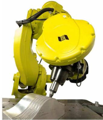
Abb. 25: Robotergestütztes FSP – System auf Basis eines Schwerlastindustriroboters (Quelle: ESAB)
