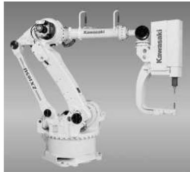
Abb. 23: FSSW Roboter System von Kawasaki [12]
