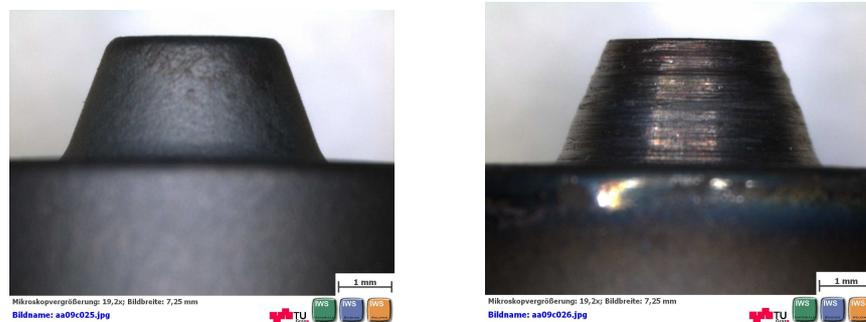
Abb. 38: Werkzeug für Dreifachblechverbindung (links) Originalzustand (rechts) nach 7 Schweißpunkten [18]
