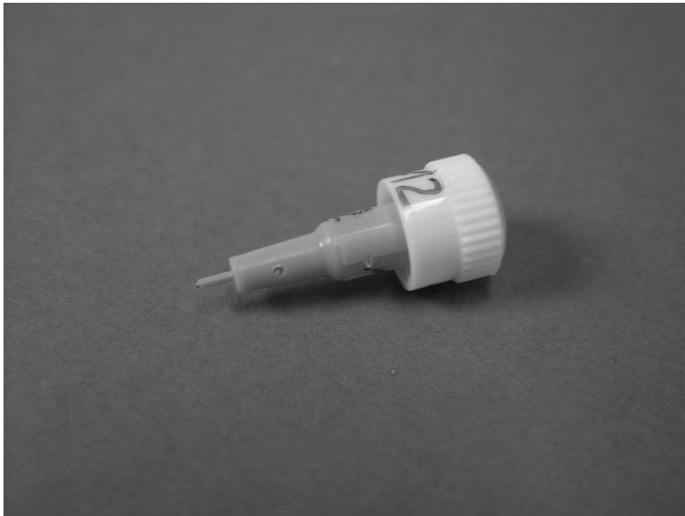
Abb. 2.8: Guide-Kanüle und Dummy im zusammengebauten Zustand
