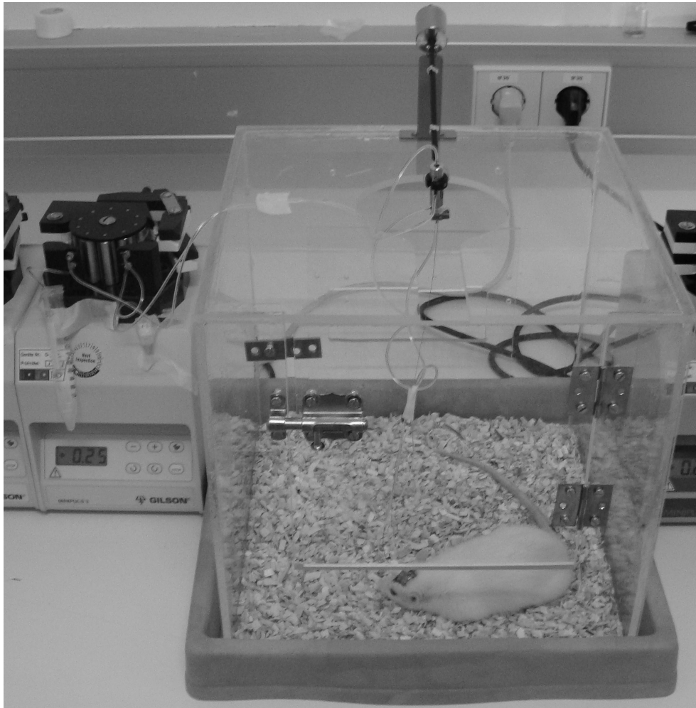
Abb. 2.32: System zur Messung an wachen, sich frei bewegendem Tieren
