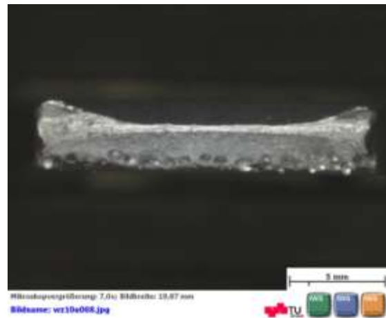
ABBILDUNG 4-36: BRUCHFLÄCHE DER ZUGPROBE MIT GERINGER STRECKENERGIE, PROBE A33
