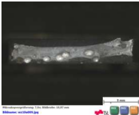
ABBILDUNG 4-35: BRUCHFLÄCHE DER ZUGPROBE MIT HOHER STRECKENERGIE, PROBE A21
