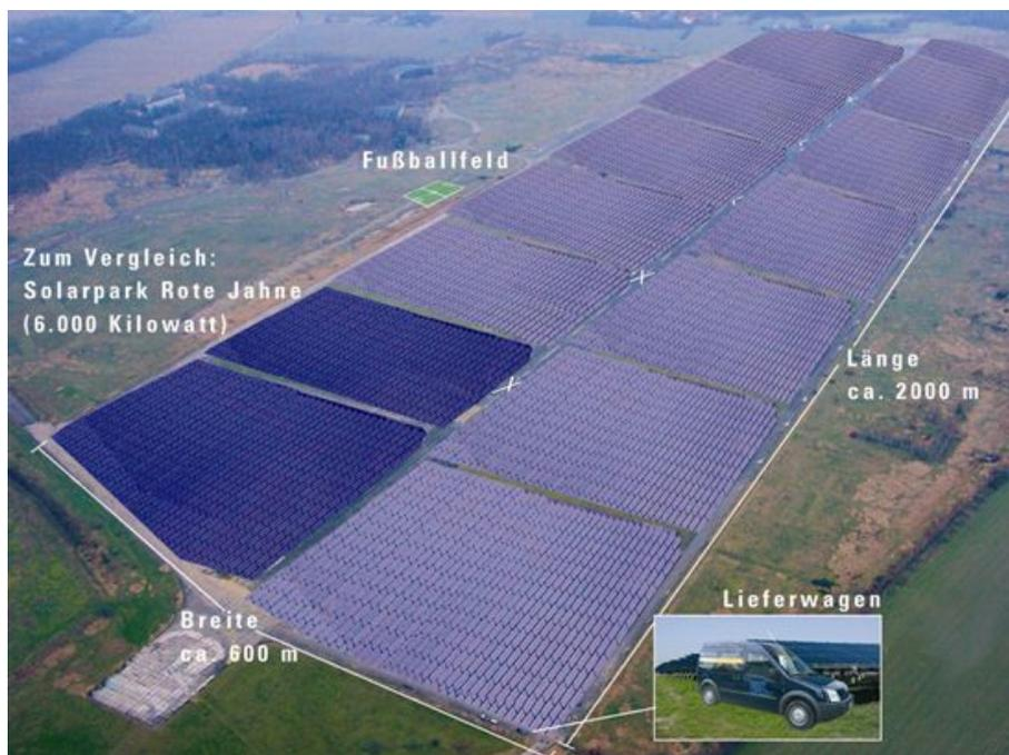
Abbildung 5.31: 40 MW PV Anlage in Brandis (Quelle: solarbuzz.com)
