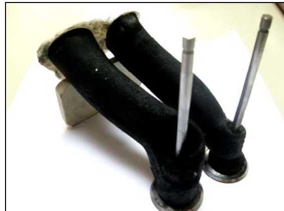
Silikonabguss Drallkanal mit Ventilen
