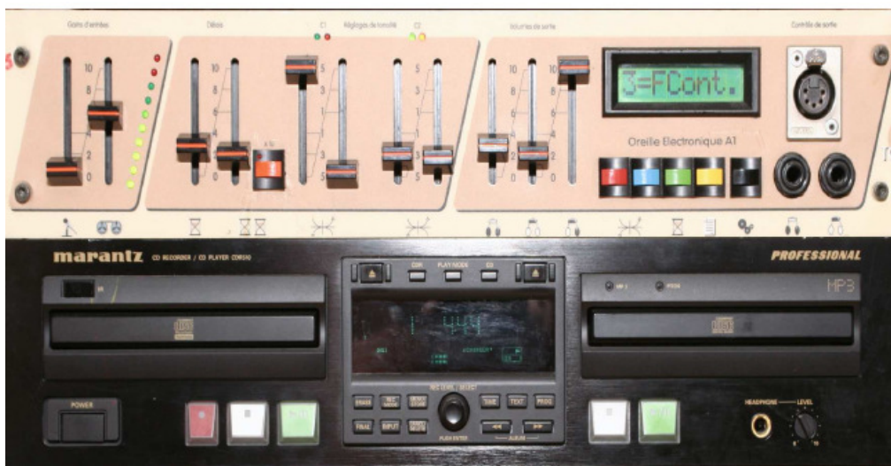
Abb. 2.23: Das klassische Elektronische Ohr (oben) mit externer Tonquelle (unten); Frontansicht der Bedienelemente, Baujahr 1991; [Tomatis2009b]
