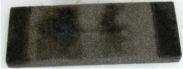
Abb. 7-3: RVC mit beschädigter Oberfläche
