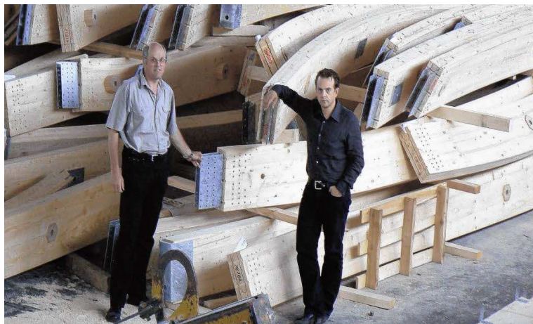
Abb. 4-10: Elemente mit eingezinkten Stahlblechen
