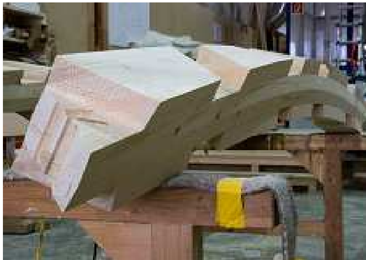
Abb. 3-15: Doppelt gekrümmter Bauteil (Yeoju Golf Resort)
