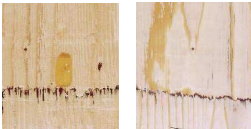
Abb. 3-21: Links Rückseite Deckfurnier ungeschliffen, rechts Rückseite Deckfurnier geschliffen
