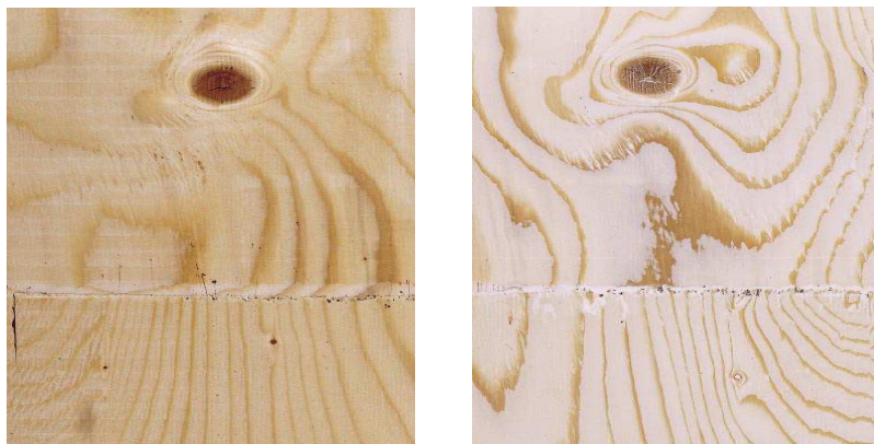
Abb. 3-20: Links Vorderseite Deckfurnier ungeschliffen, rechts Vorderseite Deckfurnier geschliffen
