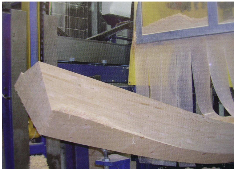
Abb. 4-27: Fünffachs-Abbundmaschine beim Zuschnitt eines doppelt gekrümmten BSH-Rohlings
