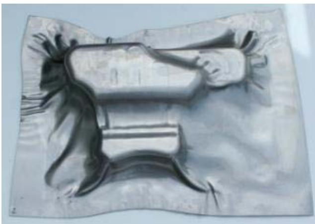
Abbildung 51: Ziehteil mit Neuordnung Bauteil 2
