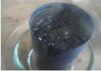
Abbildung 22 Luftblasen durch Evakuieren
