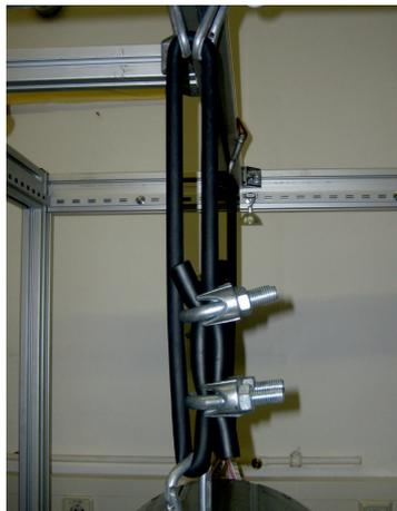
**Abbildung 3.6:** Bild der verwendeten elastischen Aufhängung
