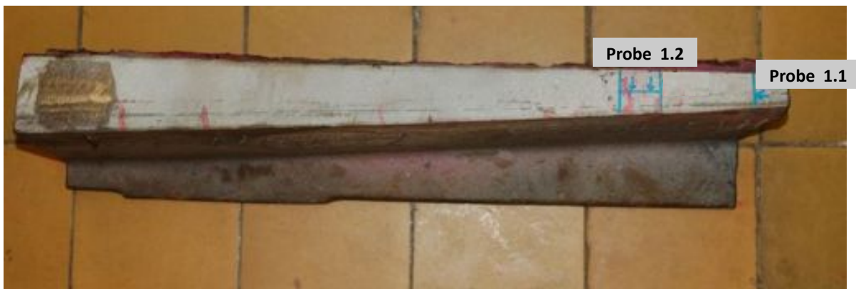
Abbildung 4.2: Fehlerhaftes Weichenherzstück, Probe 1
