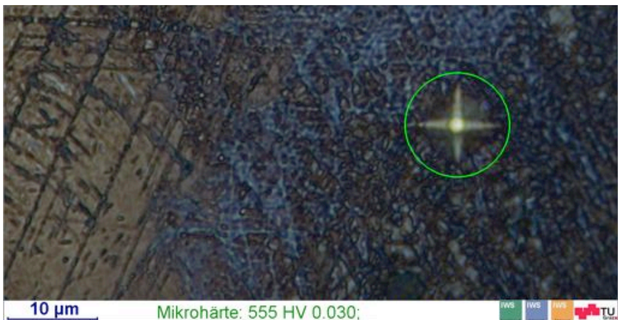
Abbildung 5.6: Probe 1.1, Härtemessung des Randbereiches; Weichenherzstück mit Rissen
