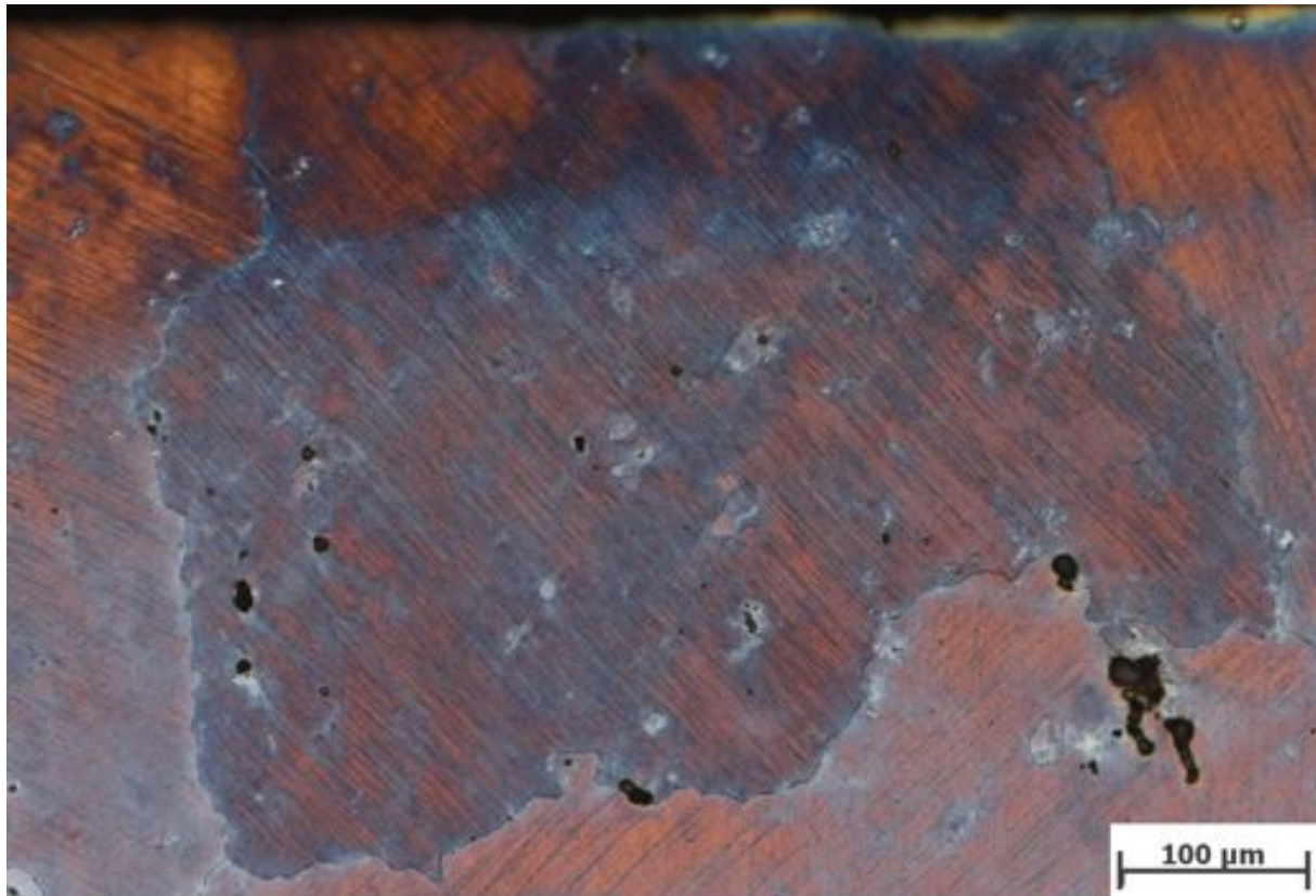
Abbildung 3.25: Schliffbild eines Manganhartstahls nach dem Sprengverfestigen mit Gleitlinien
