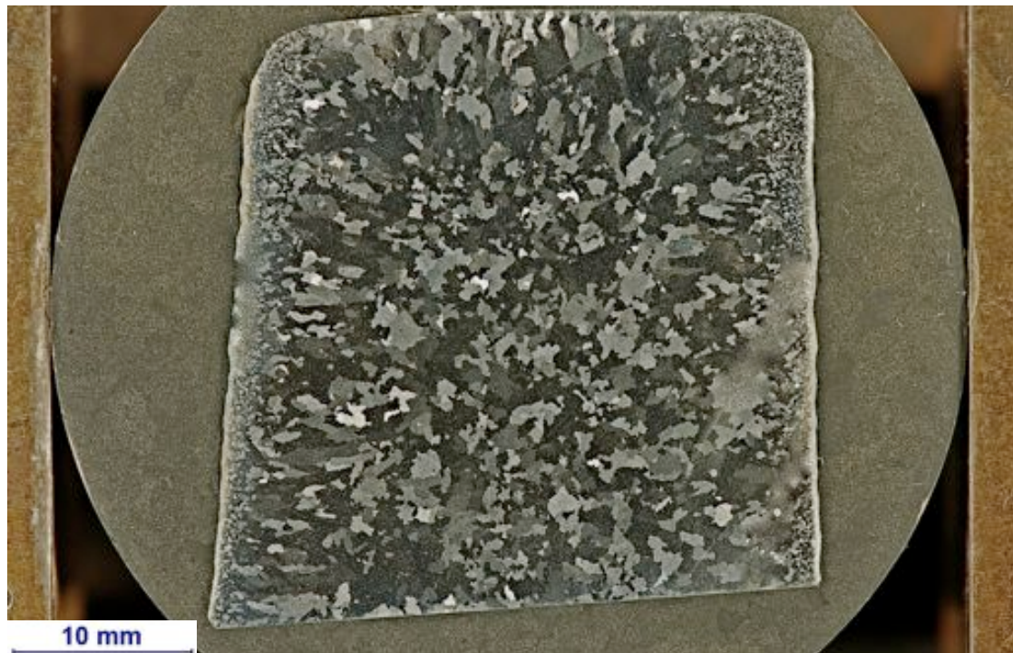
Abbildung 5.1: Probe 1.1, Makroaufnahme; Weichenherzstück mit Rissen
