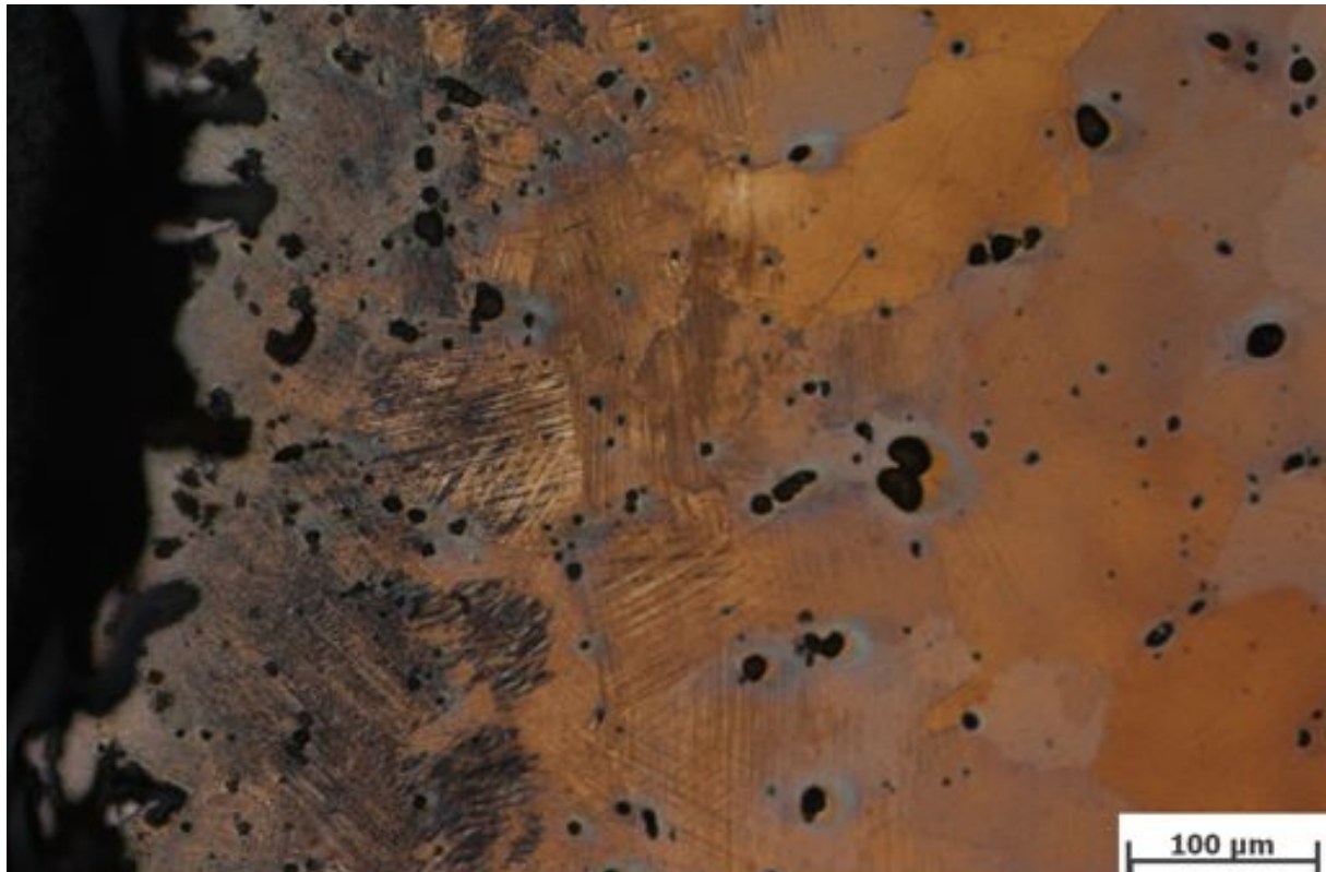
Abbildung 5.5: Probe 1.1, Martensitbildung am Randbereich; Weichenherzstück mit Rissen
