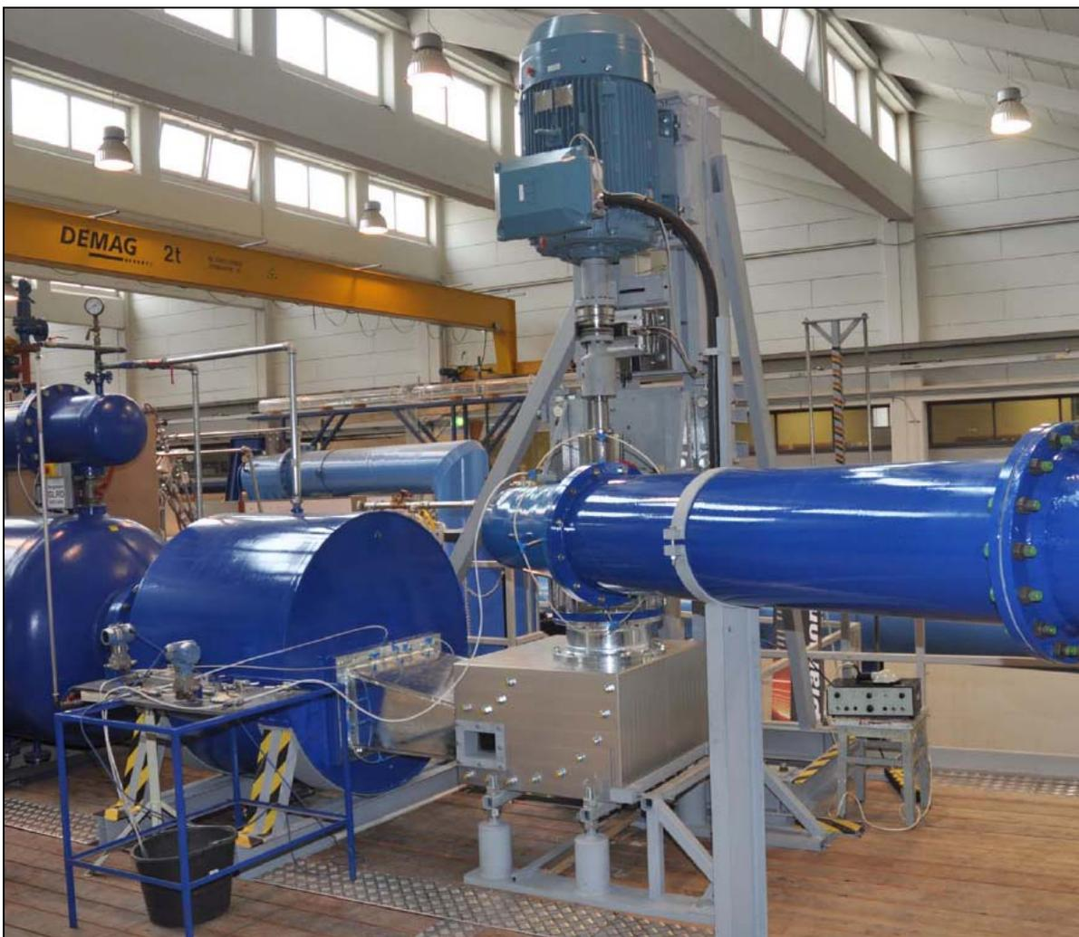
**Abbildung 4.1 – Francisturbinenprüfstand nach der Fertigstellung**
