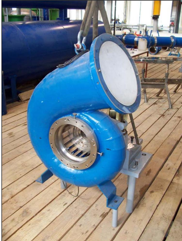
**Abbildung 2.7 – Spirale und Leitapparat des Prüfstands**
