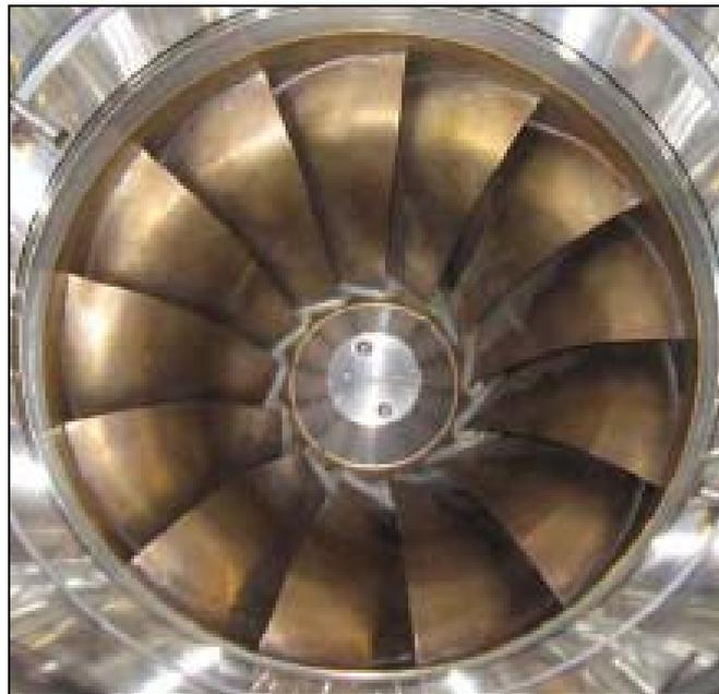
Abbildung 1.2 – Turbinenunterseite (eingebaut)
