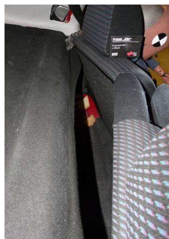
Abbildung 134: Verformung der Rückbanklehne im Experiment seitlich [44]
