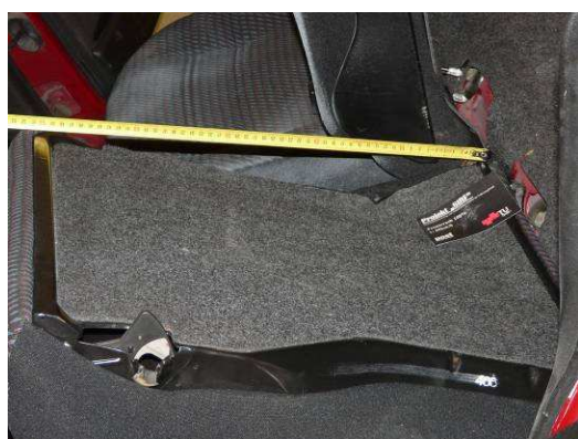
Abbildung 135: Deformationen der Rückbanklehne [44]
