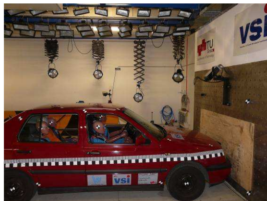
Abbildung 95: Kamera am Crashblock [44]
