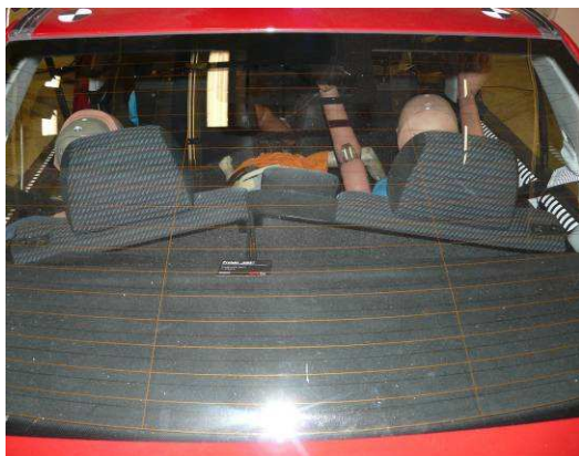
Abbildung 133: Verformung der Rückbanklehne im Experiment von hinten [44]
