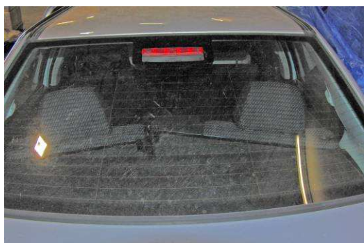
Abbildung 137: Verformung der Rückbanklehne des Unfallfahrzeuges von hinten [44]
