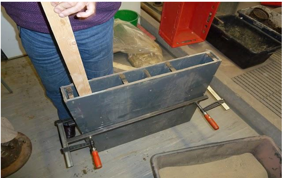
Abb. 6.10: Verdichten des Sandes auf eine vordefinierte Füllhöhe
