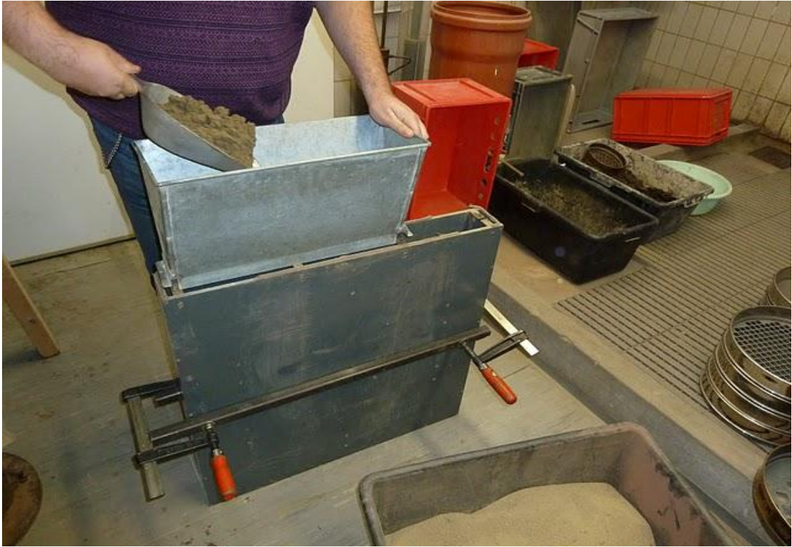
Abb. 6.9: Einbau feuchter Sand in die PVC-Form
