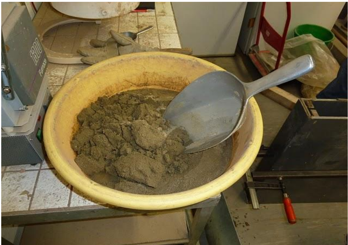
Abb. 6.8: Mischen des Sandes mit Wasser
