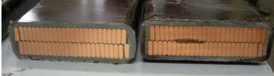
Abbildung 3: Statorstab, links: unverpresst; rechts: verpresst
