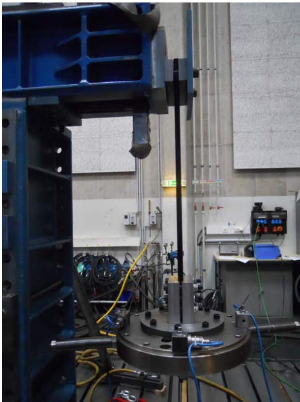
Abbildung 57: links: Torsionspendel; rechts: Torsionspendel – mit Hilfskörper zur Massenträgheitsmomentbestimmung
