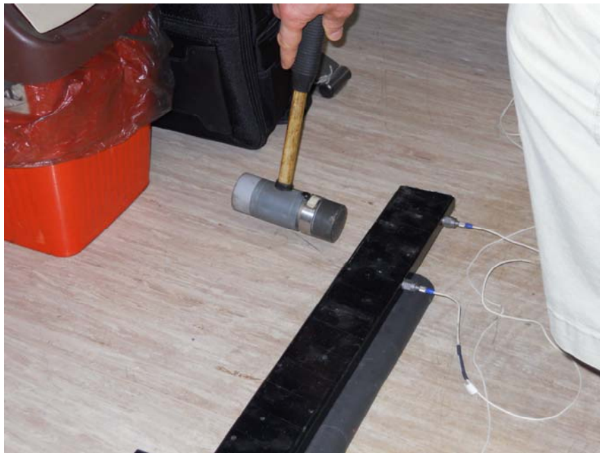
Abbildung 40: Versuchsdurchführung experimentelle Modalanalyse mit Impulshammer
