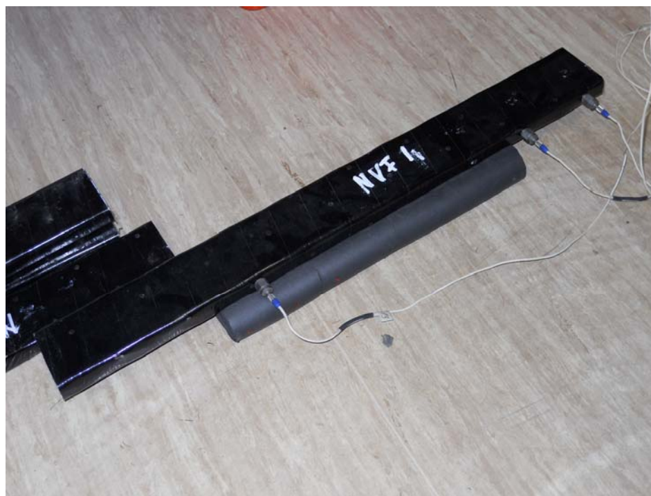
Abbildung 38: Messaufbau, Versuchsstab Typ 2, experimentelle Modalanalyse bez. y – Achse
