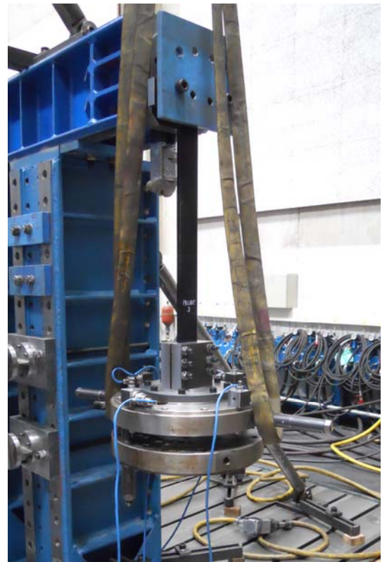
Abbildung 57: links: Torsionspendel; rechts: Torsionspendel – mit Hilfskörper zur Massenträgheitsmomentbestimmung
