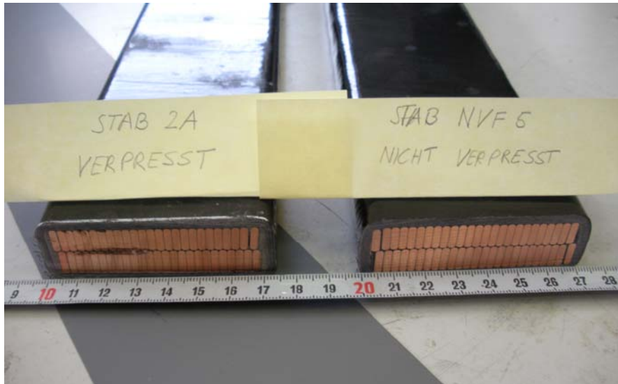
Abbildung 28: Versuchsstab Typ 1, links verpresster Stab, rechts ein nicht verpresster Stab
