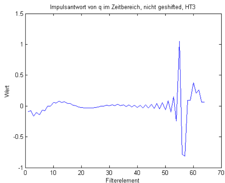
Abb. 4.21: Durch IFFT verschobene Impulsantwort Lautsprecher HT3
