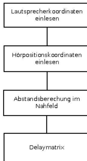
Abb. 4.11: Blockdiagramm zur Berechnung der Delay werte
