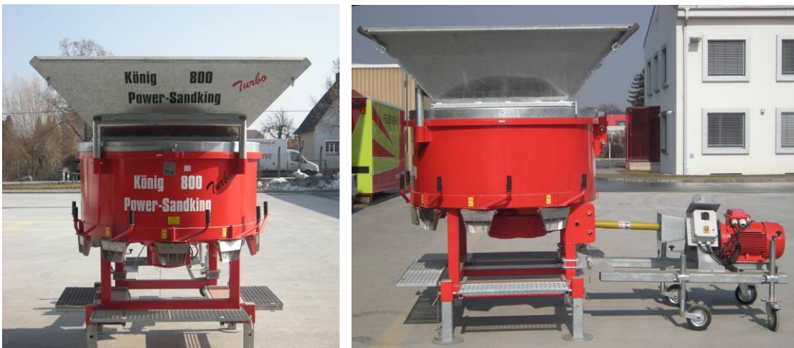
Abb. 165 Sandsackbefüllungsmaschine der Stadt Graz [192]
