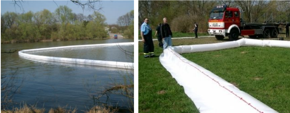
Abb. 85 Luftgefülltes Schlauchwehrsystem als Ölsperre, Trockenübung [96]
