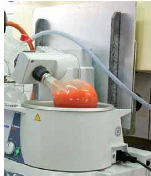
22 Der Rotationsverdampfer wird in der Aromaküche eingesetzt. Geschmacksträger können mit diesem Gerät auf Wasserbasis destilliert werden. Ätherische Öle werden so aus Lebensmitteln freigesetzt. Aus den entstandenen Destillaten lassen sich aromatische Schäume oder Suppen zubereiten.
