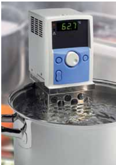
29 Das sousvide Thermostat mit kontrollierter Tempera- tur und Wärmezirkulation ermöglicht eine exakte Tem- perierung – selbst bei Nieder- temperaturen in belie- bigen Gefäßen. Zuvor vakuumierte Lebens- mittel werden mit der Nieder- temperatur-Vakuumgarmethode schonend zubereitet, ohne dabei Flüssigkeit zu verlieren. Vitamine, Proteine und Aromen bleiben somit erhalten.
