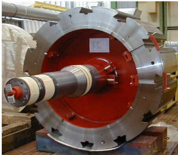
Abbildung 1-10 Ausführung des Rotors als massiver Jochring
