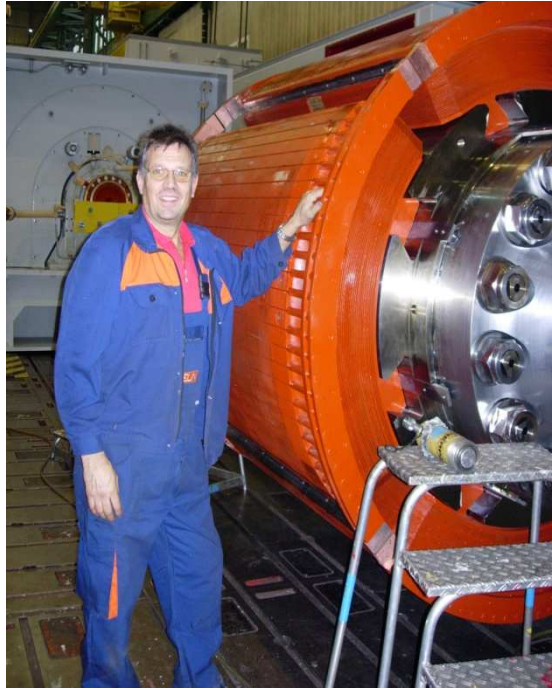
Abbildung 1-9 Ausführung des Rotors als Vollwelle
