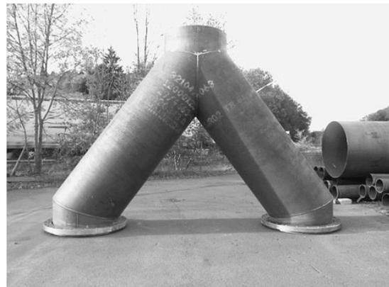
Abbildung 2.5: links: Asymmetrischer Rohrverzweiger [6] – rechts: real ausgeführtes, symmetrisches Hosenrohr
