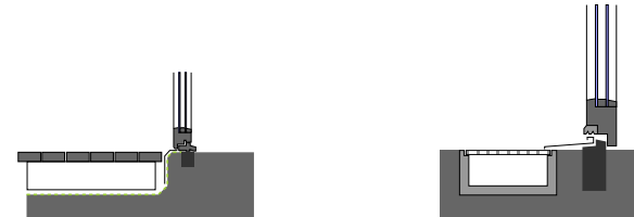
Abb. 34 Systembeispiele für eine barrierefreie Balkonausbildung Quelle: Barrierefreies Bauen für alle Menschen + ÖNORM B1600
