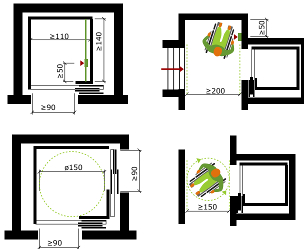
Abb. 33 Beispiele für Aufzugskabinen mit Bewegungsfläche vor dem Aufzug Quelle: Barrierefreies Bauen für alle Menschen + ÖNORM B1600
