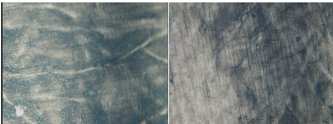
Abbildung 40: Lichtmikroskopaufnahme von LTO auf dem Kupfervlies; links Kalandrierstufe 0,75; rechts Kalandrierstufe 0,5
