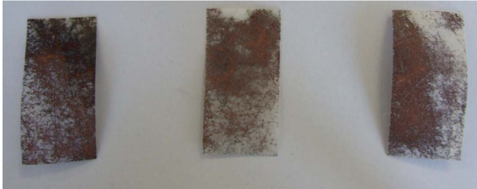
Abbildung 18: Abscheidung auf Vlies mit Vorbehandlung mit \text{KMnO}_4 , links: Lösung1, 60 min; Mitte: Lösung1, 30 min; rechts: Lösung 2, 30 min
