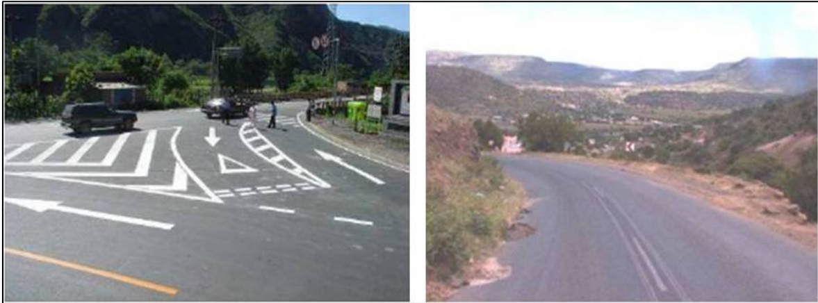
Abbildung 8 Beispiel für eine gute und eine schlechte Straßenmarkierung [7]
