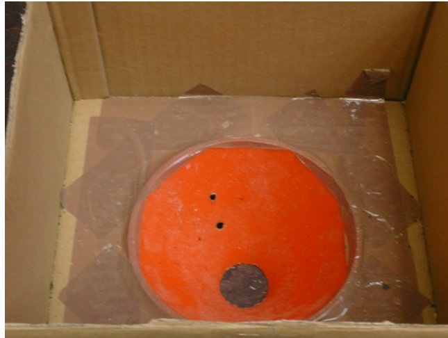
Abb. 4.12: Alternatives Dosiersystem für einen Massendurchsatz von 300 kg/h
