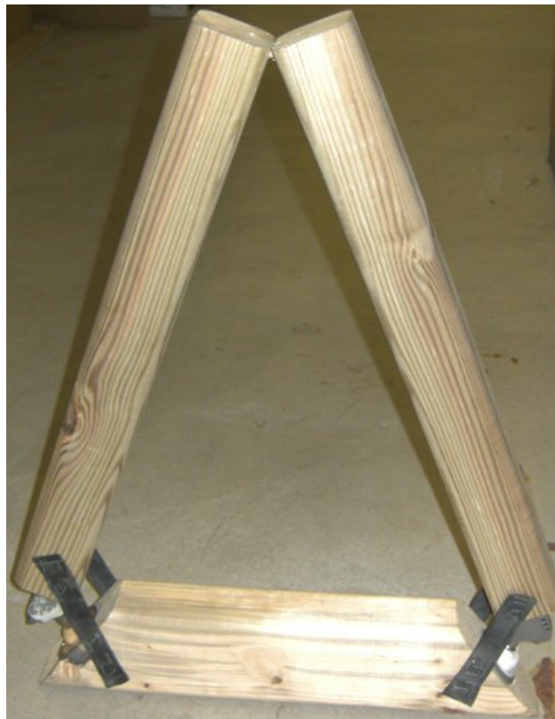
Abbildung 3.12.: Konstruktion aus Holz in der zwei HTEP für experimentielle Zwecke (Untersuchung von Abriebgeräuschen und zur Lokalisierung von Körperschallquellen) befestigt sind.
