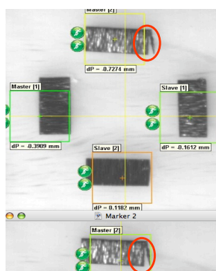
Bild 2: Verschiebung des Positionsfensters des Extensiometers zu Beginn und am Ende einer Testkurve
