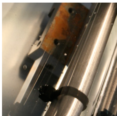
Bild 5: Schmutzpartikel im Testbecken nahe der Heizrohre.
