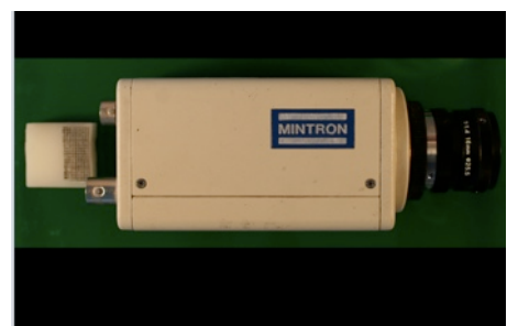
Bild 3: CCD-Kamera mit Objektiv zur Dickenbestimmung mit wechselbarem Objektiv.
