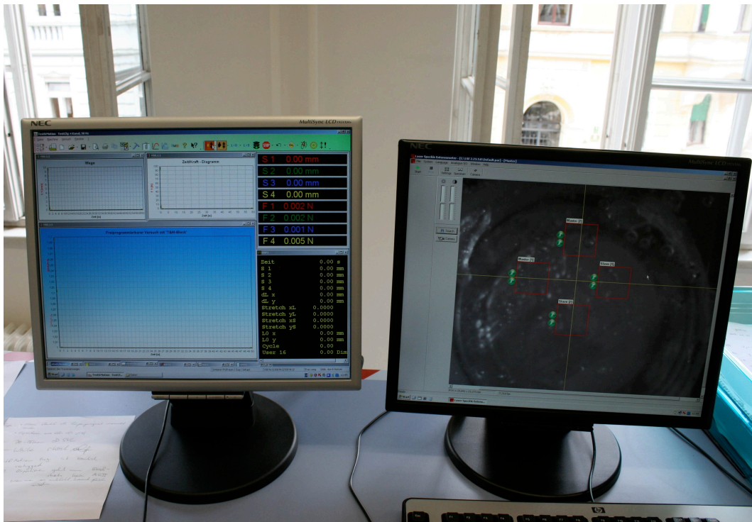
Abbildung 8 – Steuer- und Messcomputer (links „Doli“-Mess-Software, rechts "Laser-SpeckleSoftware)
