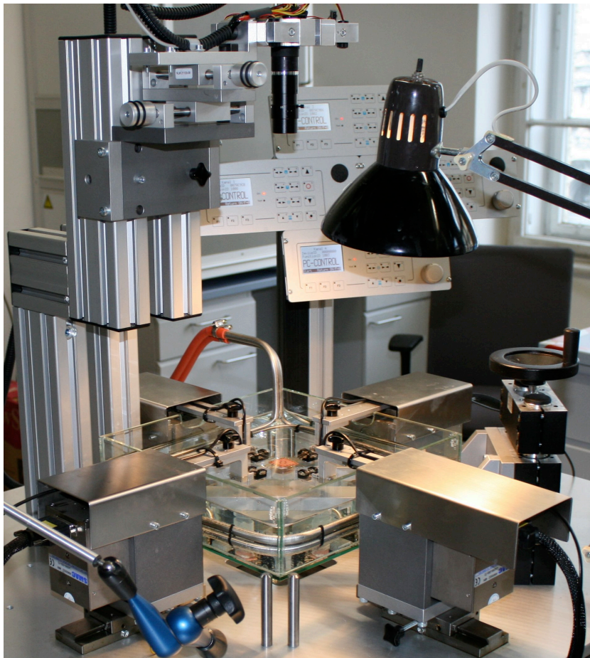
Abbildung 7 – Biaxialprüfmaschine am Institut für Biomechanik
