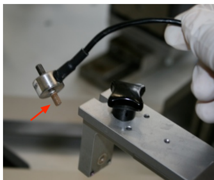
Bild 2: Kraftmessdose mit korrodiertem Schraubzylinder (Pfeil).
