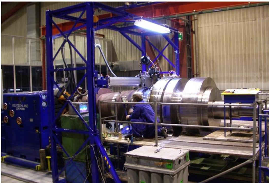
Fig. 3.6: Horizontal welding stand "Deutschland"
