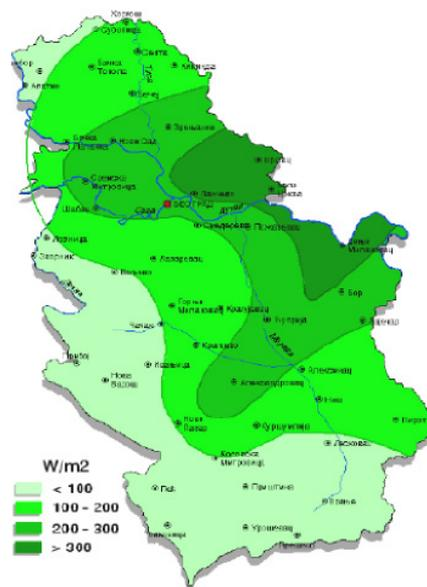
**Abbildung 27:** Durchschnittliche jährliche Windkraft in Serbien auf 100 m Höhe über dem Boden (Durisic, et al., 2009)
