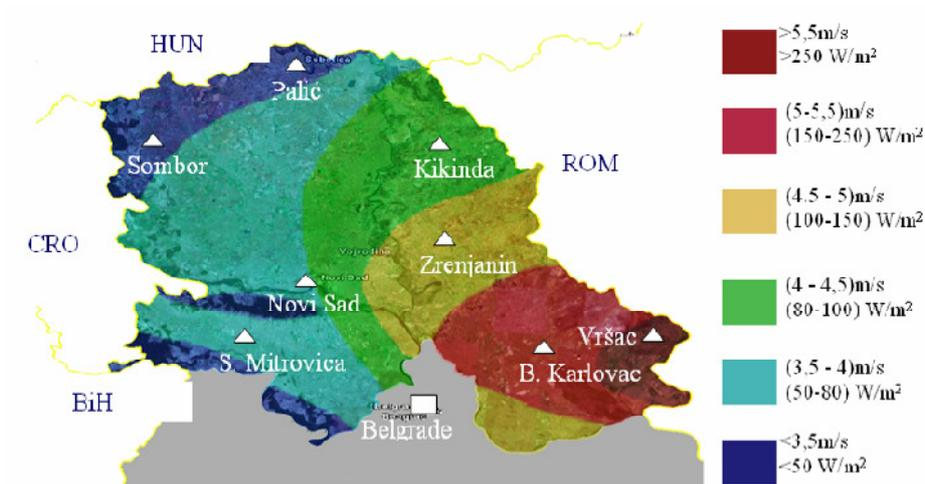
**Abbildung 28:** Durchschnittliche jährliche Windgeschwindigkeit und Wind-Karte der Region Vojvodina in 50 m Höhe über dem Boden (Durisic, et al., 2009)
