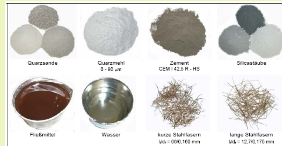
Abbildung 42: Mischungsbestandteile zur Herstellung von UHFB (mit Stahlfasern)
