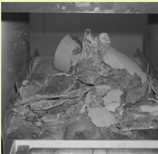
Abbildung 43: Schlagartig gebrochener Prüfcylinder aus UHFB ohne Stahlfasern
