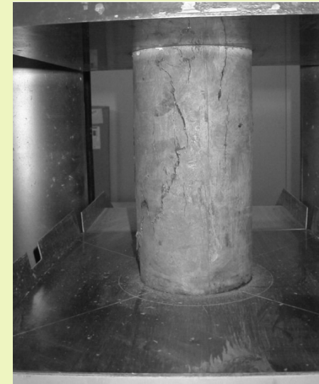
Abbildung 44: Prüfcylinder aus UHFB mit 2,5 Vol.-% Stahlfasern
