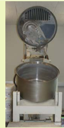
Abbildung 40: Mischer für UHFB an der TU Graz
