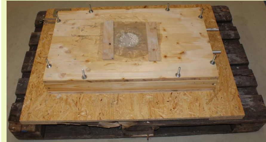
Abbildung 48: Abdeckung eines geschalteten Bauteils aus UHFB
