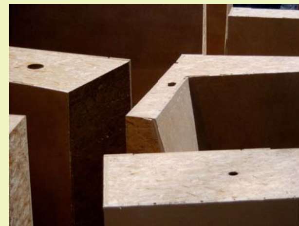
Abbildung 87: Schalelemente aus Holz vor ihrem Einsatz
