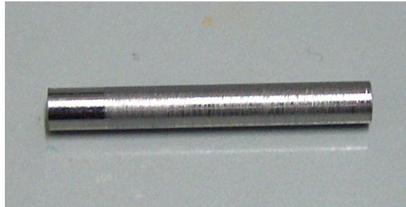
Abbildung 43: Wolfram nach mechanischer Vorbehandlung mittels Diamantwerkzeug
