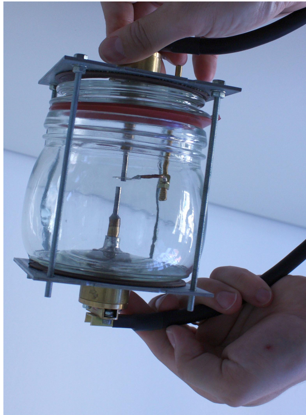
Abbildung 21: Gesamtansicht Schaltfunkenstrecke unjustiert vor Einbau des Specksteinisolators für die Triggerelektrode
