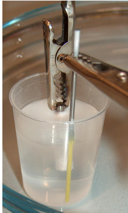
Abbildung 44: Wolfram wird in Natronlauge geätzt
