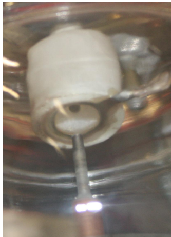
Abbildung 22: Detailansicht Haupt- und Triggerelektrode mit Specksteinisolator
