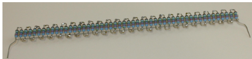
Abbildung 23: Hochspannungswiderstand aus 50 Stück 0207-Widerständen aufgebaut (Spannungsfestigkeit min. 15kV)
