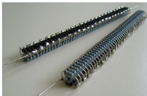
Abbildung 13: Hochspannungsgleichrichterelemente Ober- und Unterseite
