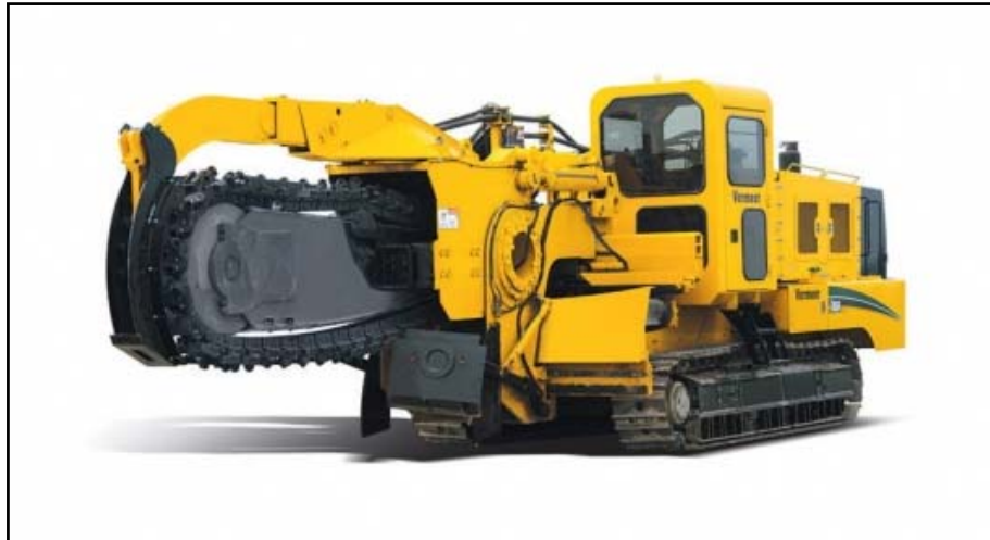
Abb. 6.7: Grabenfräse, T858 Commander III (Vermeer 2009)
