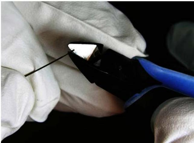
Abb. 15: Verkürzen des Katheters mit einem Seitenschneider
