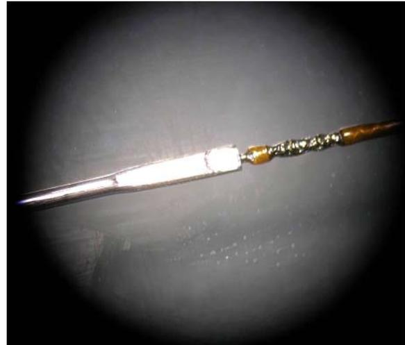
Abb. 54: Katheter geklebt an die gecrimpte Kanüle und Stützdraht
