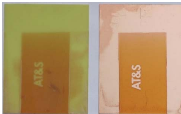
Abbildung 47: Beschichtungen von AZ 4533 Positivlack, erhalten durch dip coating auf FR 4 (links) und Kupfer-Substraten (rechts).
