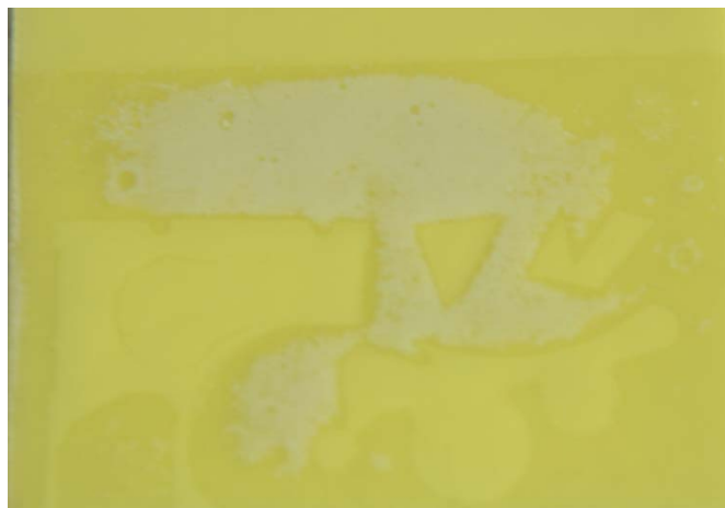
Abbildung 49: Eine Poly(2-ethyl-2-oxazolin-co-2-(9'-decenyl)-2-oxazolin)-Beschichtung, die nach dem Entwickeln große Fehlstellen aufweist.
