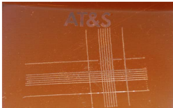
Abbildung 48: Beispiel für einen Gitterschnitttest von AZ 4533 Positivlack auf einer Kupferoberfläche.
